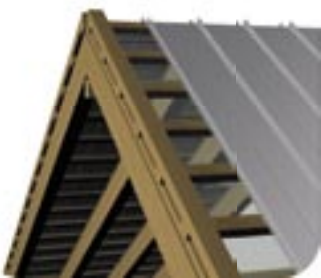
RYS. 21 Montaż deski szczytowej
