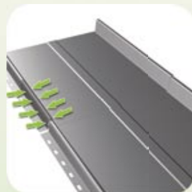
RYS. 19 Po dopasowaniu paneli - zaklepać miejsce połączenia
