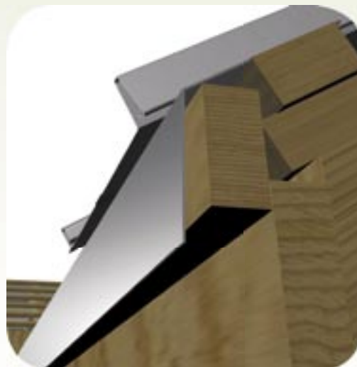
RYS. 9 Panel wysuwamy poza okap - 4-5 cm
