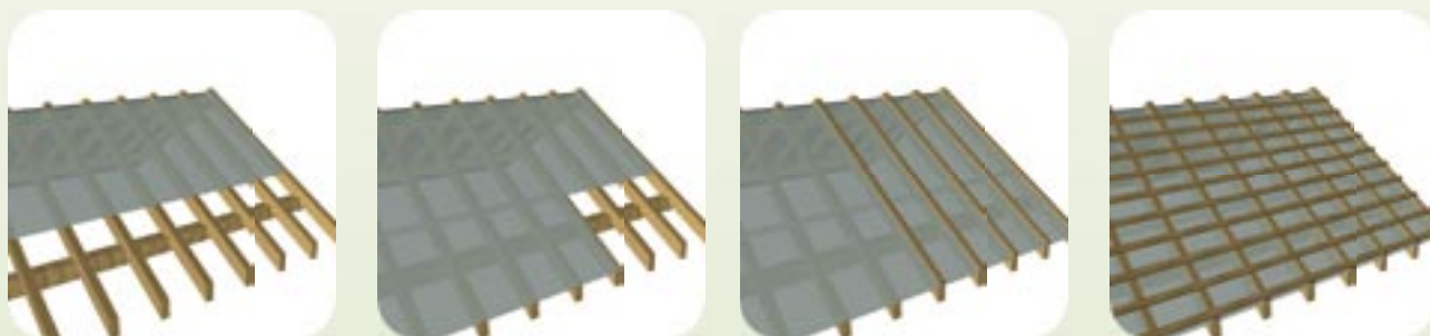
RYS. 5 Kolejne etapy montażu folii, kontrłat i łat
