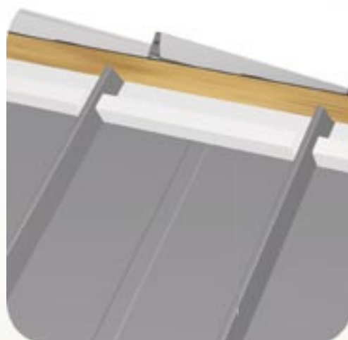
RYS. 29 Długość obróbki pośredniej dostosowana do szerokości panela - 280 lub 480 mm
